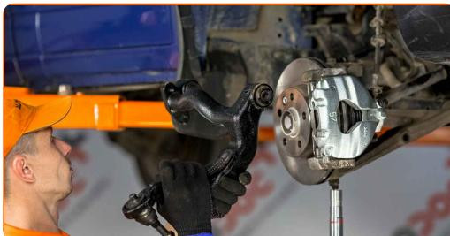
**Udskiftning: forreste øvre arm – VW Transporter IV Ladvogn / Chassis (70E, 70L, 70M, 7DE, 7DL). Råd fra AUTODOC eksperter:**
