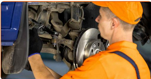
**18** Behandel befæstigelsen der forbinder forbindelsesstangen og styrespindlen. Brug kobberfedt.
