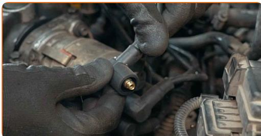
**Udskiftning: tændkabler – VW Transporter T4 Bus (70B, 70C, 7DB, 7DK, 70J, 70K, 7DC, 7DJ). Råd:**
