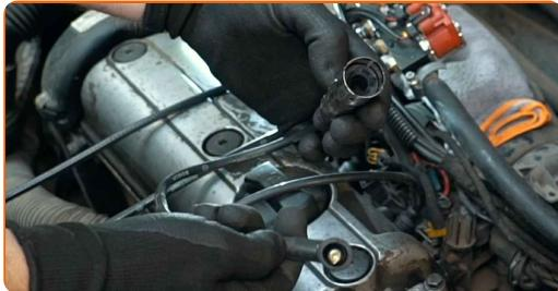
Udskiftning: tændkabler – VW Transporter T4 Bus (70B, 70C, 7DB, 7DK, 70J, 70K, 7DC, 7DJ). Råd fra AUTODOC eksperter:
