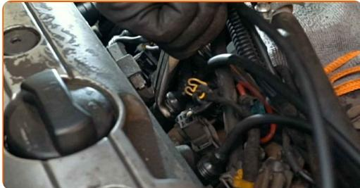
Udskiftning: tændkabler – VW Transporter T4 Bus (70B, 70C, 7DB, 7DK, 70J, 70K, 7DC, 7DJ). AUTODOC eksperter anbefaler:
