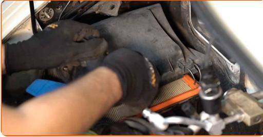
11 Fjern filterelementet fra filterhuset.
