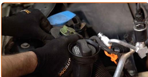
7 Løsn klemmen og fjern slangen til luftindsugningen fra filterhuset. Brug vandpumpe tænger.
