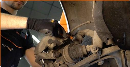
**Udskiftning: bremseslange – VW Transporter T4 Ladvogn / Chassis (70E, 70L, 70M, 7DE, 7DL, 7D). Fagfolk anbefaler:**
