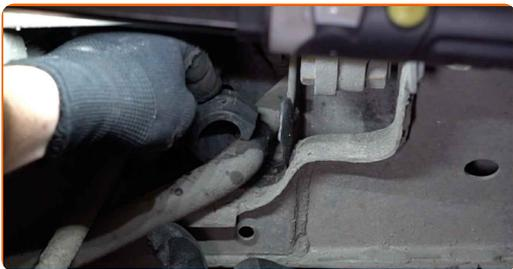
**12** Installer stabiliseringsbøsning beslagene. Brug et koben.
