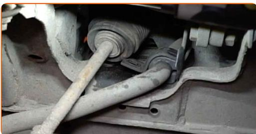
**13** Skru befæstigelserne af stabiliseringsbøsning beslagene. Brug en topnøgle №16. Brug en momentnøgle. Stram den til 45 Nm moment.
