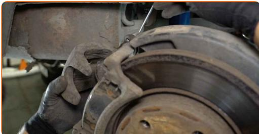
Udskiftning: bremseskiver – VW Transporter V Bus (7HB, 7HJ, 7EB, 7EJ, 7EF, 7EG, 7HF, 7EC). Råd fra AUTODOC eksperter:
