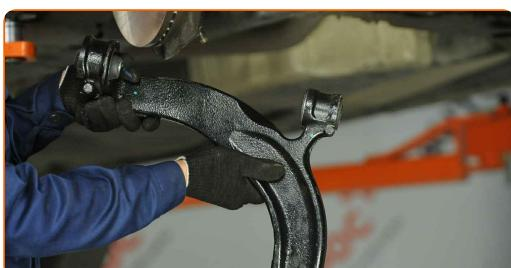
**Udskiftning: forreste nedre arm – VW Transporter V Bus (7HB, 7HJ, 7EB, 7EJ, 7EF, 7EG, 7HF, 7EC). Fagfolk anbefaler:**
