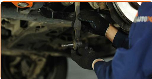
**13** Rengør montagestedet til styrekuglen. Brug en stålbørste. Brug WD-40 spray.
