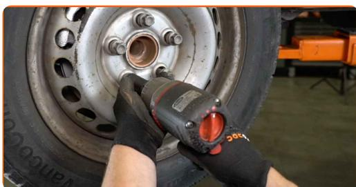
**24** Sænk bilen og stram hjulboltene på kryds med. Brug hjul slag nøgle #19. Brug en momentnøgle. Stram den til 180 Nm moment.
