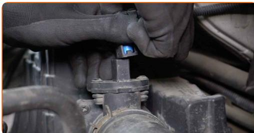
**4** Frigør luftindsugningsslanguens klemmer. Brug spændebåndstænger.
