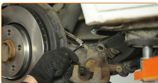
**16** Installer og fastmonter bremseslangen på den nye kaliber.
