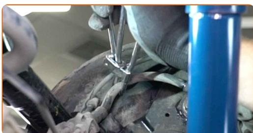
**14** Skru bremseslangen af bremsekaliberen. Brug en kombinøgle № 14.
