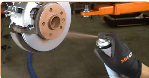
**32** Rengør bremseklivens overflade. Brug bremserens.
