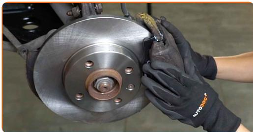
**24** Monter støvhætter på bremsekaliberens styretapper.
