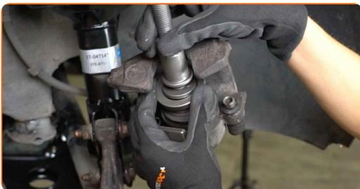
**23** Monter bremsekaliberen og sæt den fast. Brug HEX nr. H7. Brug en momentnøgle. Stram den til 25 Nm moment.
