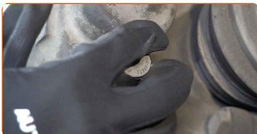
**25** Behandle overfladen hvor bremseeskiven har kontaktflade til hjulnavet. Brug kobberfedt.
