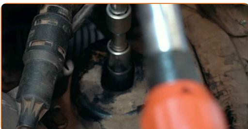
76 Fjern understøtning under gearkassen.
