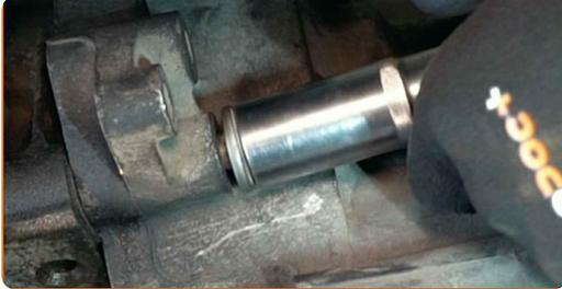
**68** Stram gearkassens fastgørelse til motorblokken. Brug en topnøgle N°18. Brug en momentnøgle. Stram den til 64 Nm moment.
