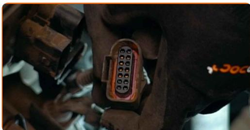
11 Frigør motorens ledningsnet.
