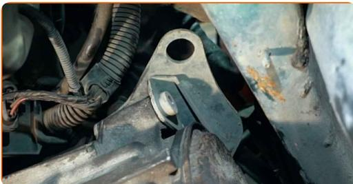
**70** Skru fastgørelsen der forbinder gearkassen med det underste fæste fast. Brug en kombinøgle N° 16.
