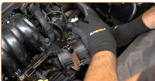
**8** Løsn fastgørelseselementet på den sekundære luftpumpebeslag. Brug HEX nr. H6. Brug en topnøgle N°13. Brug en skraldenøgle.
