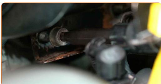
**9** Fjern det sekundære luftpumpebeslag.
