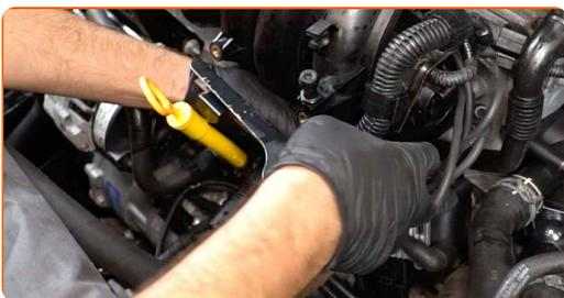
**21** Stram fastgørelseselementerne på det sekundære luftpumpebeslag. Brug HEX nr. H6. Brug en topnøgle №13. Brug en momentnøgle. Stram den til 9 Nm moment.
