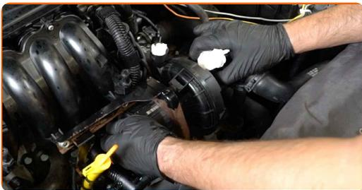
**23** Skru fastgørelseselementerne, der forbinder den sekundære liftpumpe til dens beslag fast. Brug en kombinøgle N° 10.
