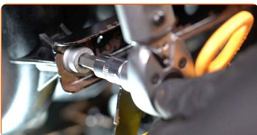
**22** Montér den sekundære luftpumpe.
