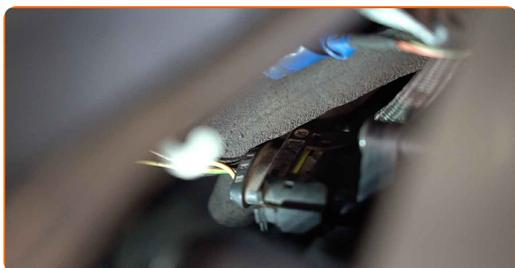
18 Fastgør klammen på luftindsugningsslangen. Brug en topnøgle №7. Brug en skraldenøgle.
