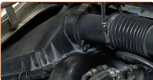
4 Afbryd luftindsugningsrør fra luftfilterhuset. Brug et koben.
