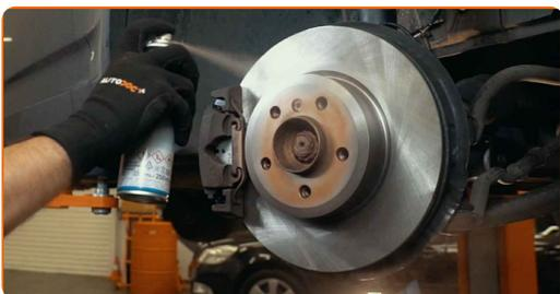
**20** Rengør bremseskivens overflade. Brug bremsrens.
