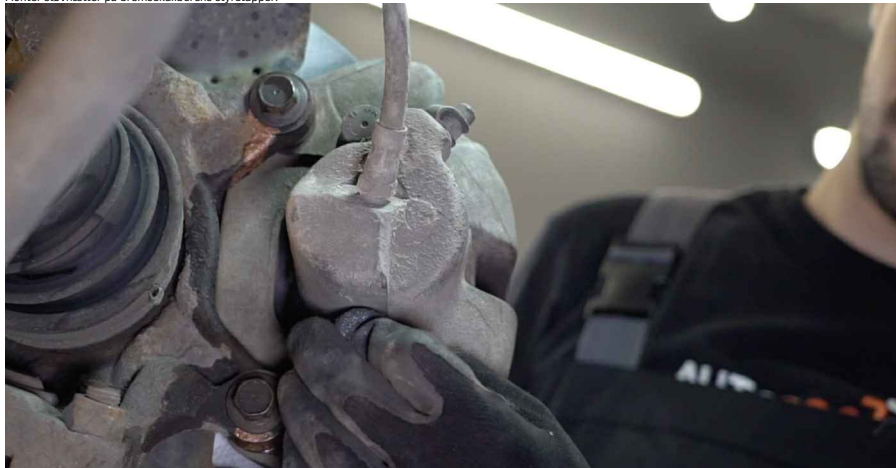
32 Monter bremsekaliberens holdefeder.
