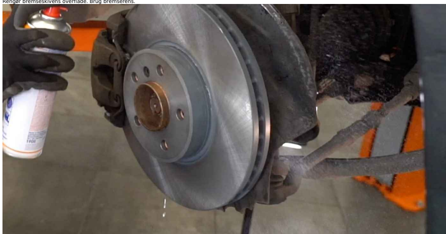
33 Rengør bremseklivens overflade. Brug bremserens.
