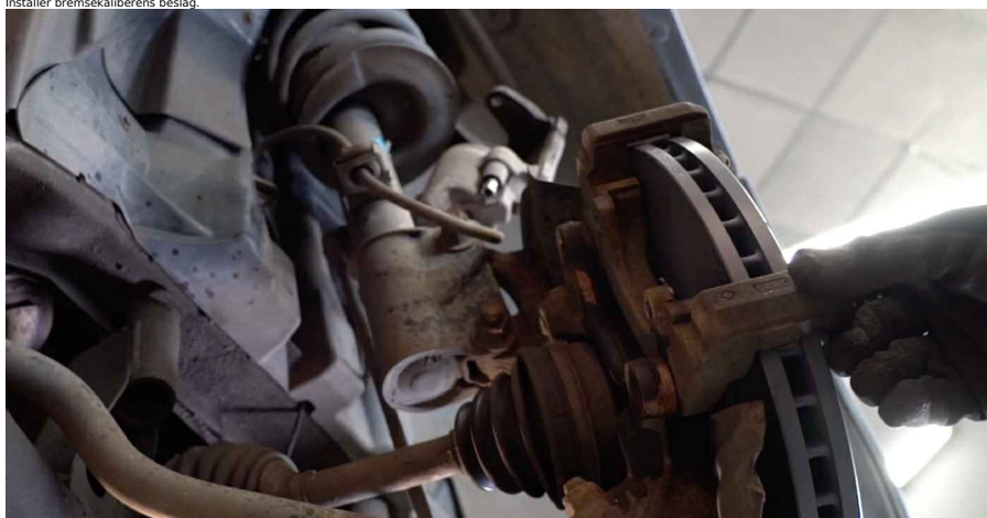
26 Stram bremsekaliberens beslag. Brug en topnøgle N-16. Brug en momentnøgle. Stram den til 110 Nm moment.
