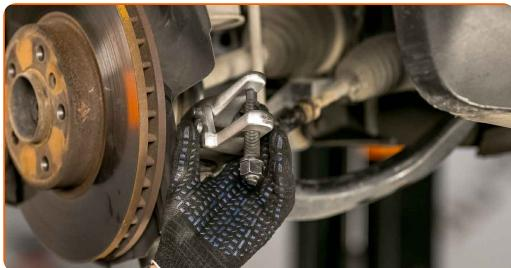
**12** Skru enden ud af sporingsstangen. Brug en kombinøgle № 13.
