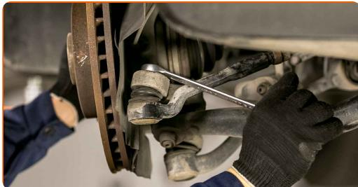
**11** Tag sporingsstangens ende af styrekuglen. Brug en lejeaftrækker.
