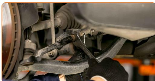
**8** Rengør befæstigelsen der forbinder forbindelsesstangen og styrespindel. Brug en stålbørste. Brug WD-40 spray.
