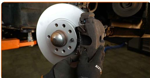
**21** Behandle overfladen hvor bremseeskiven har kontaktflade til hjulnavet. Brug kobberfedt.
