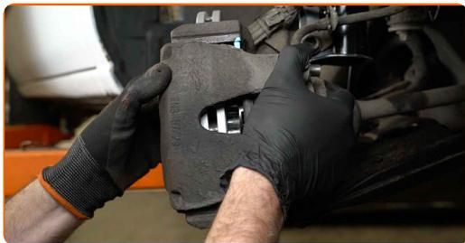
**19** Monter støvhætter på bremsekaliberens styretapper.
