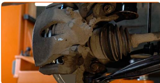
**20** Monter bremsekaliberens holdefjeder.
