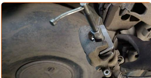
**21** Monter bremsekaliberen og sæt den fast.
