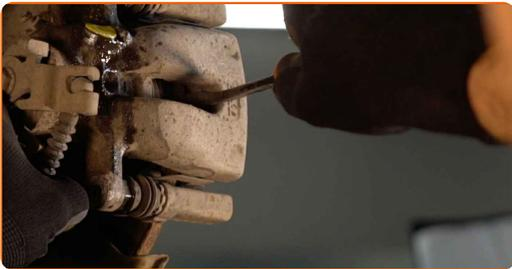
**14** Fjern bremsekaliberen. Brug et koben.
